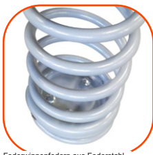
Federwippenfedern aus Federstahl, Feder-Ø 200 mm, Stab-Ø 20 mm; verzinkt und mit UV-beständigen Polyesterfarben pulverbeschichtet.
