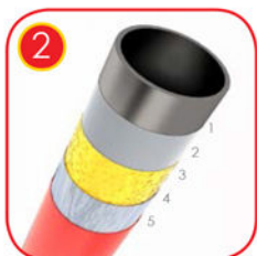
Verzinkte Stahlpfosten mit farbiger Pulverbeschichtung nach RAL QUALICOAT zertifiziert 1 Stahl 2 Sandstrahlung 3 Eisenphosphat 4 Verzinkung 5 Polyesterpulverbeschichtung
