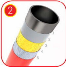
Verzinkte Stahlposten mit farbiger Pulverbeschichtung nach RAL QUALICOAT zertifiziert 1 Stahl 2 Sandstrahlung 3 Eisenphosphat 4 Verzinkung 5 Polyesterpulverbeschichtung
