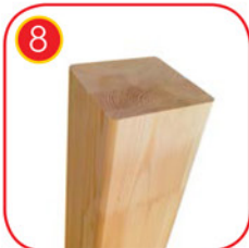
Pfosten aus Kernlosen, PU-verleimten Nadel Schichtholz 2fach Kesseldruckimprägniert. Dimension 90 x 90 mm
