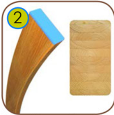
Bogenstützen aus Kernlosen, PU-verleimten Nadel Schichtholz 2fach Kesseldruckimprägniert und mit Umweltfreundlichen Farben lackiert Dimension 9x26x280 cm
