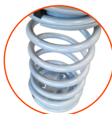
FEDER AUS FEDERSTAHL, Ø 200 MM, STAB-Ø 20 MM, VERZINKT UND MIT POLYESTER-PULVERLACK BESCHICHTET
