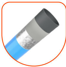
SOLIDE KONSTRUKTION AUS SCHWARZSTAHL S235JR, SANDGESTRAHLT; ZWEISCHICHTIG PULVERBESCHICHTET: ZINKREICHER PRIMER + RAL-DECKLACK.
